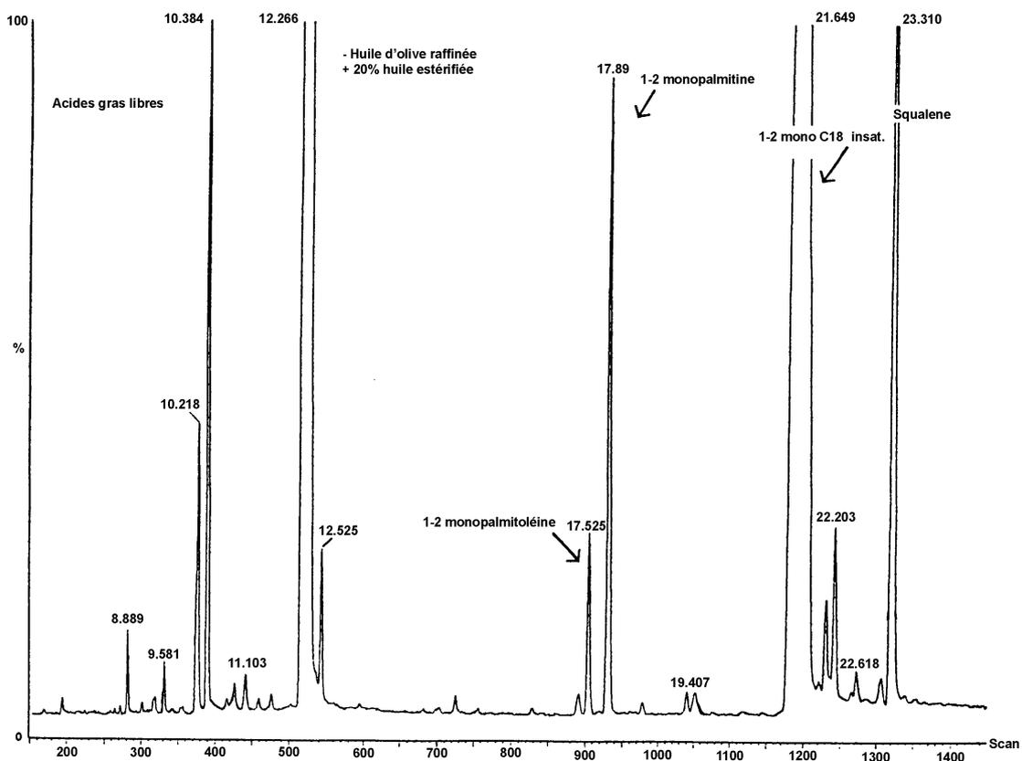
Chromatogramme des produits de la réaction de silanisation obtenus par l'action de la lipase sur une huile d'olive raffinée additionnée de 20% d'huile esterifiée (100%).
