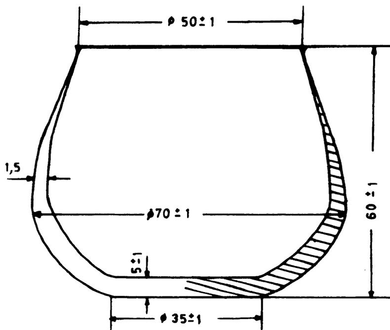
Fig. 2 Dispositivo de calentamiento de las muestras
