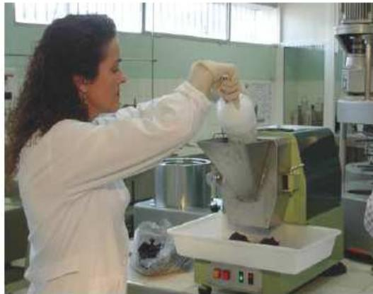
Fig. 3 : Broyeur à marteaux
