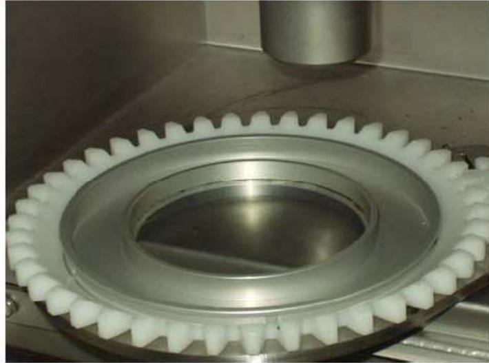
Fig. 15 : Couronne dentée permettant de mesurer différentes zones de l'échantillon
