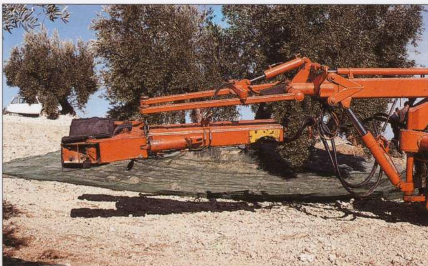
Λεπτομέρεια της κεφαλής δονητή πολλαπλών κατευθύνσεων κορμών που χρησιμοποιείται στη μηχανική περισυλλογή της ελιάς.
