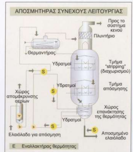
ΔΙΑΓΡΑΜΜΑ 16. Αποσμητήρας συνεχούς λειτουργίας.
