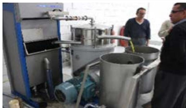
Fig 6: Separatore centrifugo per l'olio di oliva
