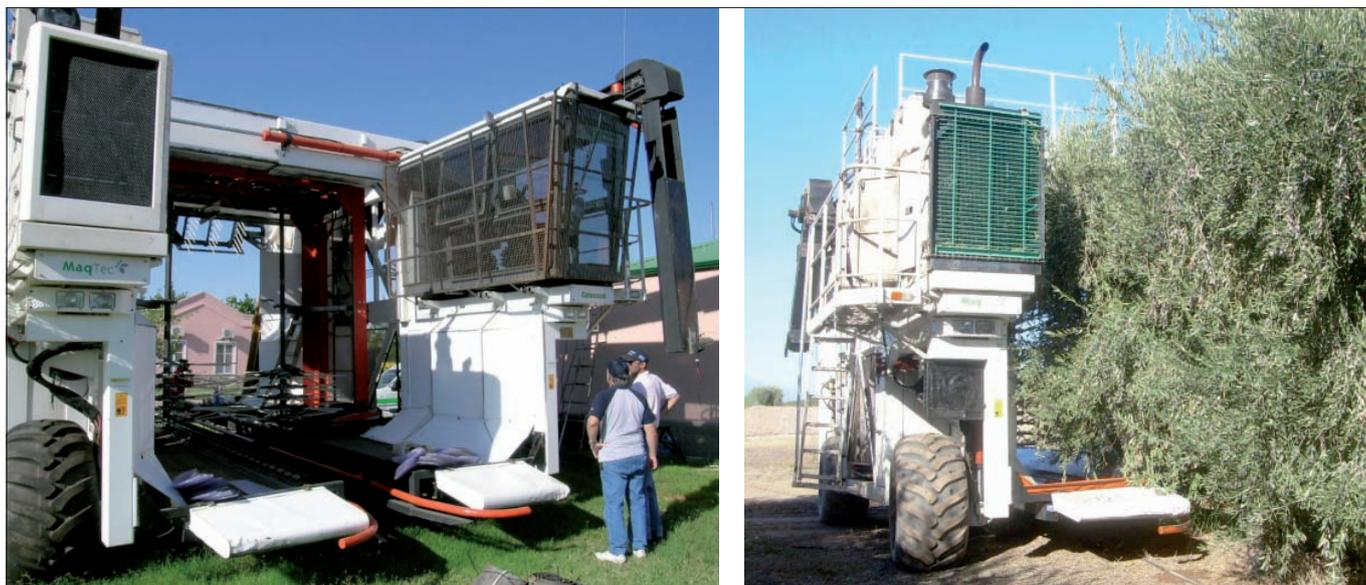
Fotografia 17. Macchina “scavallatrice” (Colossus) per la raccolta di varietà da olio. Permette la raccolta su alberi fino a 4 m di altezza e 4 m di diametro.
