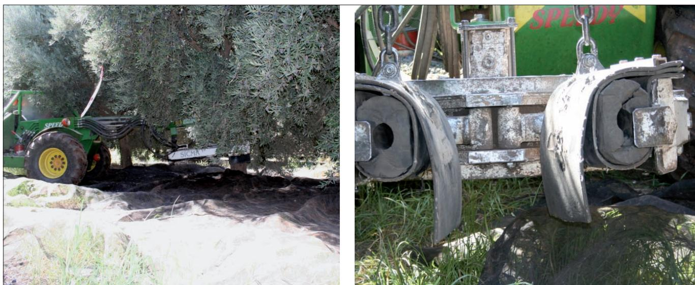
Fotografia 16. Vibratore di tronco per la raccolta dell'oliva da frantoio. Si sta utilizzando efficacemente anche in alberi di grande dimensione (fino a 5 m di altezza) a condizione che la potatura sia adeguata a trasmettere la vibrazione.
