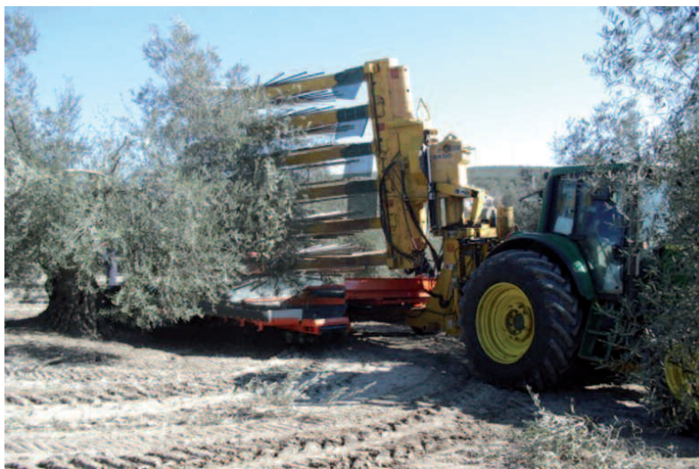
Fig. 2. Scuotitore della chioma e intercettatore adattati agli oliveti tradizionali
