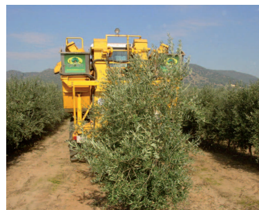
Fig. 4. Scavallatrice per oliveti intensivi (a sinistra) e oliveti a siepone ad alta densità (a destra)
