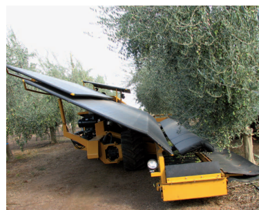
Fig. 3. Scuotitore del tronco con intercettatore a ombrello rovesciato (a sinistra) e scuotitore laterale (a destra) in oliveto intensivo
