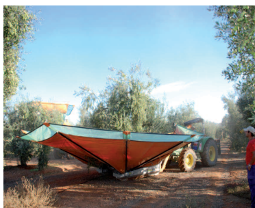
Fig. 3. Scuotitore del tronco con intercettatore a ombrello rovesciato (a sinistra) e scuotitore laterale (a destra) in oliveto intensivo
