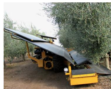
Fig. 4. Cosechadora cabalgante para olivares intensivos (izquierda) y de alta densidad en seto (derecha)
