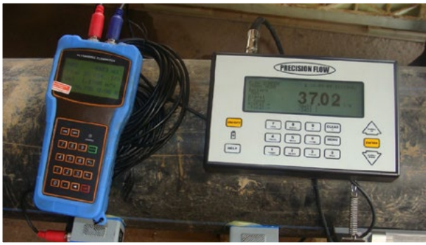
الشكل ٢ - قياس تدفق التفريغ في محطة الضخ باستخدام مقياس التدفق بالموجات فوق الصوتية (حقول خاندان)
