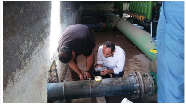
الشكل ١ - مراقبة تدفق التفريغ عند مدخل محطة التحكم المركزية باستخدام مقياس التدفق بالموجات فوق الصوتية
