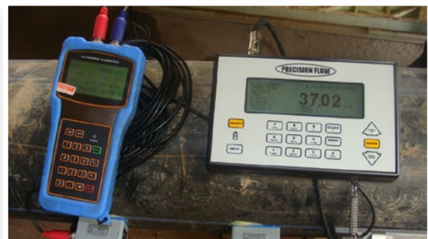
Illustration 2 Mesure du débit de déversement au poste de pompage à l'aide d'un débitmètre à ultrasons (vergers de Khandan)
