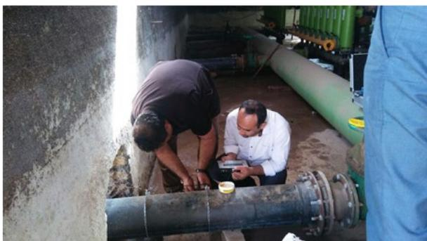
Figura 2. Medición del caudal de descarga en la estación de bombeo mediante un caudalímetro ultrasónico (olivares de Khandan)
