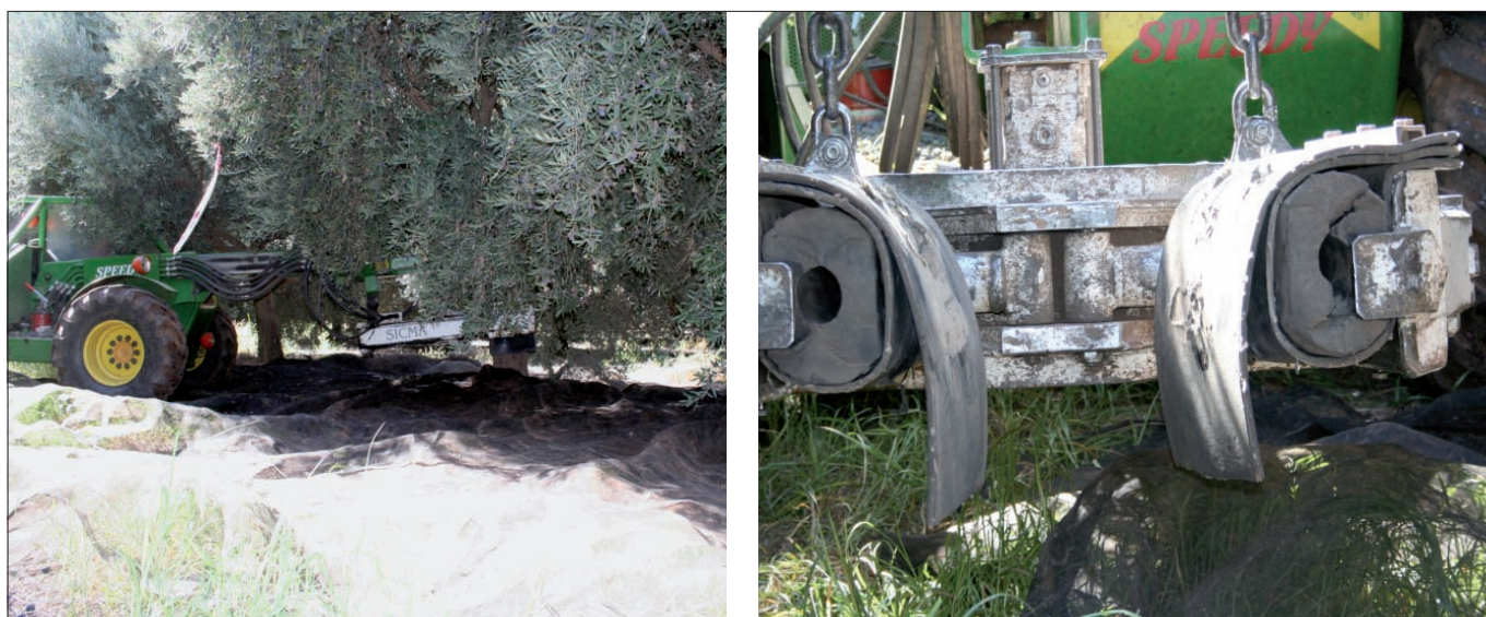
Photo 16. Vibreur de tronc pour la récolte des olives destinées à l'huile. Cette méthode donne de bons résultats même avec des arbres caractérisés par des troncs élevés (jusqu'à 5 m de haut), à condition que la taille ait été réalisée correctement pour transmettre la vibration.
