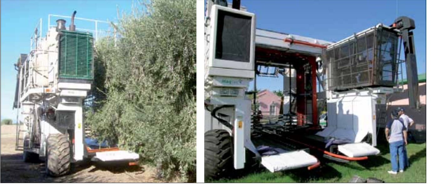
الصورة رقم 17. أداة حصاد عملاقة "كولوسوس" لأصناف الزيت. تستطيع هذه الأداة حصاد أشجار يصل ارتفاعها إلى 4 م، ويبلغ قطرها 4 م.
