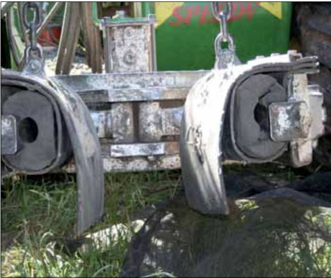
الصورة رقم ١٦. هزاز الجذوع الذي يُستخدم لحصاد الزيتون المخصص لإنتاج الزيت. ولا يزال يُجرى استخدامه بنجاح في الأشجار ذات الأحمال الكبيرة (التي تصل إلى ٥ أمتار) شريطة أن يكون التقليم مناسب لنقل الهزاز.
