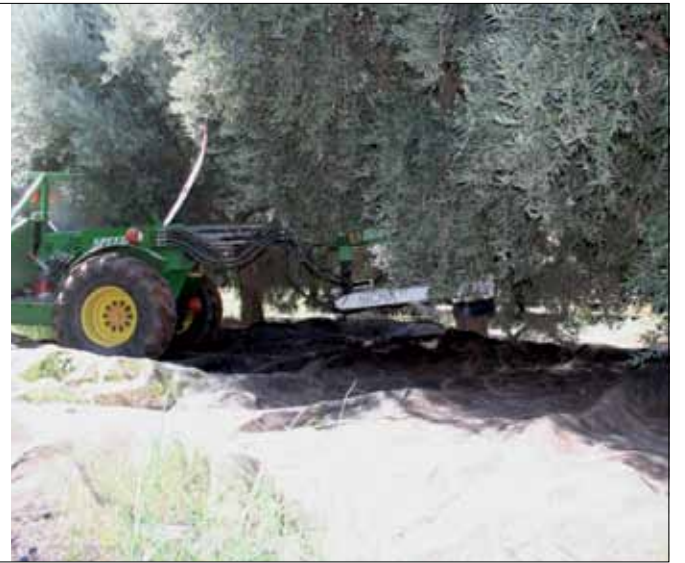
الصورة رقم ١٦. هزاز الجذوع الذي يُستخدم لحصاد الزيتون المخصص لإنتاج الزيت. ولا يزال يُجرى استخدامه بنجاح في الأشجار ذات الأحمال الكبيرة (التي تصل إلى ٥ أمتار) شريطة أن يكون التقليم مناسب لنقل الهزاز.
