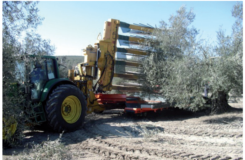
الشكل (2): هزازة الظلة/ الأغصان وإطار الالتقاط المطور للاستخدام مع حقول الزيتون التقليدية
