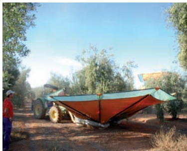
الشكل (3): هزازة الجذوع ذات المظلة المقلوبة (على اليمين) وهزازة الجذوع الجانبية (على اليسار) في حقول الزيتون المكثفة
