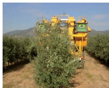
الشكل (4): حصادة التفريز لحقول الزيتون المكثفة (على اليمين) والحقول ذات السياج عالية الكثافة (على اليسار)
