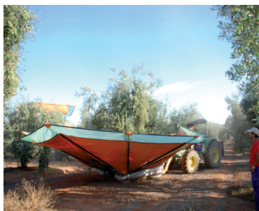
Fig. 3. Vibreur de tronc à parapluie inversé (à gauche) et vibreur de tronc parallèle (à droite) dans une oliveraie intensive
