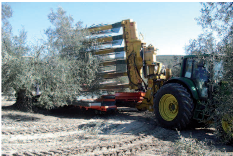
Fig. 2. Vibreur de frondaison et récepteur adaptés aux oliveraies traditionnelles
