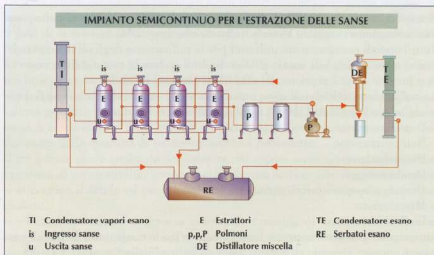
FIGURA 9. Impianto semicontinuo per l'estrazione delle sanse.
