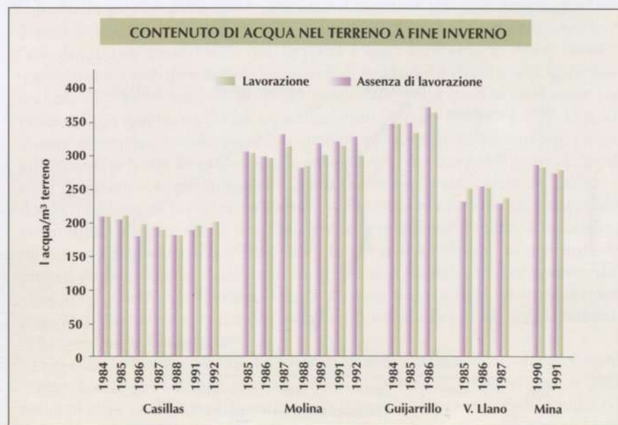
FIGURA 10. Nelle zone mediterranee il 75% circa della pluviometria totale annuale si produce nel periodo autunno-inverno, con l'impiego da parte dell'olivo dell'acqua immagazzinata nel terreno in questo periodo per il suo consumo durante la stagione asciutta. Nella figura si presenta il contenuto di acqua nel terreno all'inizio della primavera in 5 prove ed in anni diversi, in L e NL. Malgrado la riduzione della velocità di infiltrazione in NL (Figura 9) le disponibilità di acqua in L e NL non sono state molto differenti.
