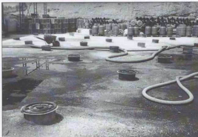
Cisterne di poliestere sotterranee per la fermentazione di olive nere.
