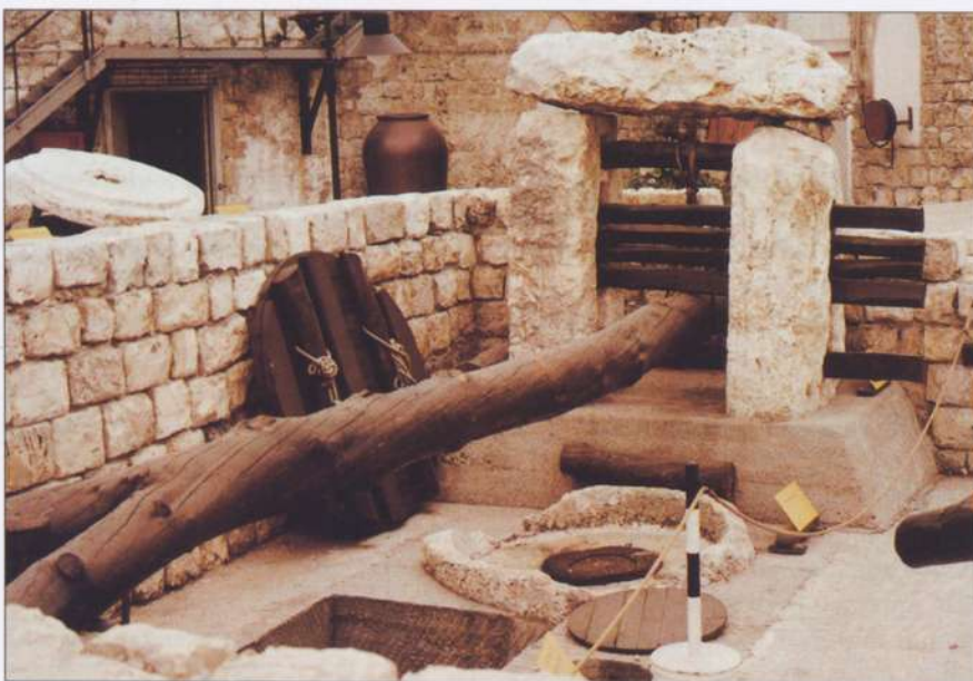
Restauro di frantoio a leva e vite: due arbores che sostengono l' unculum del prelum , ara e orbis olearus .
