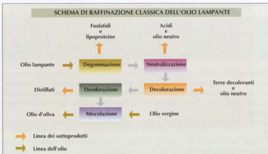
FIGURA 10. Schema di raffinazione classica dell'olio lampante.
