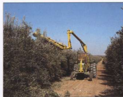
Nelle piantagioni intensive si può applicare la potatura meccanica. I dischi rotativi della potatrice producono tagli che permettono di mantenere la piantagione entro il volume di chioma desiderato.
