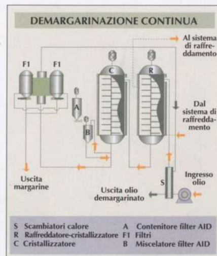
FIGURA 17. Sistema di demargarinazione continua.
