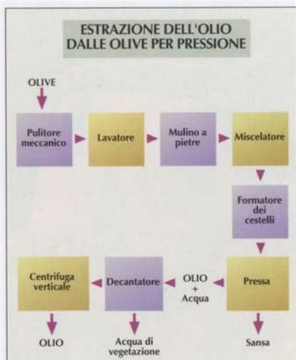
FIGURA 2. Estrazione dell'olio dalle olive per pressione.
