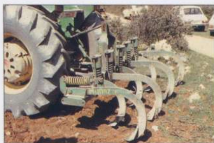
Per la lavorazione dell'oliveto si utilizza il coltivatore in molti impianti. La lavorazione verticale è più raccomandabile dell'utilizzazione del versoio o dell'erpice a dischi.
