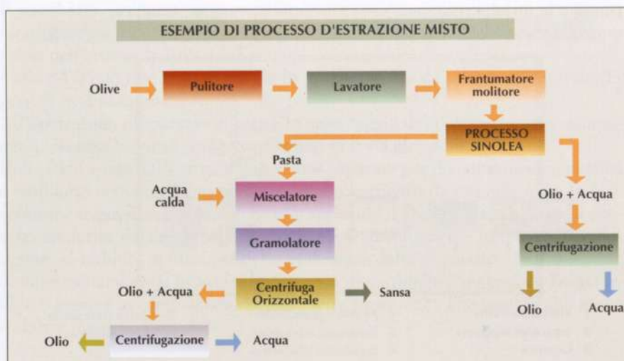
FIGURA 8. Esempio di processo d'estrazione misto.
