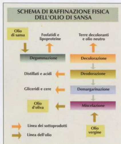
FIGURA 12. Schema di raffinazione fisica dell'olio di sansa.
