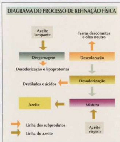
FIGURA 11. Diagrama do processo de refinação física.
