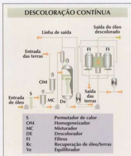
FIGURA 15. Descoloração contínua.
