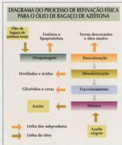
FIGURA 12. Diagrama do processo de refinação física para o óleo de bagaço de azeitona.
