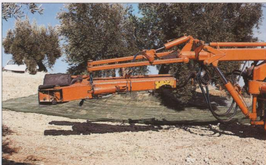
Pormenor da cabeça de um vibrador multidireccional de tronco, utilizado na colheita mecânica da azeitona.
