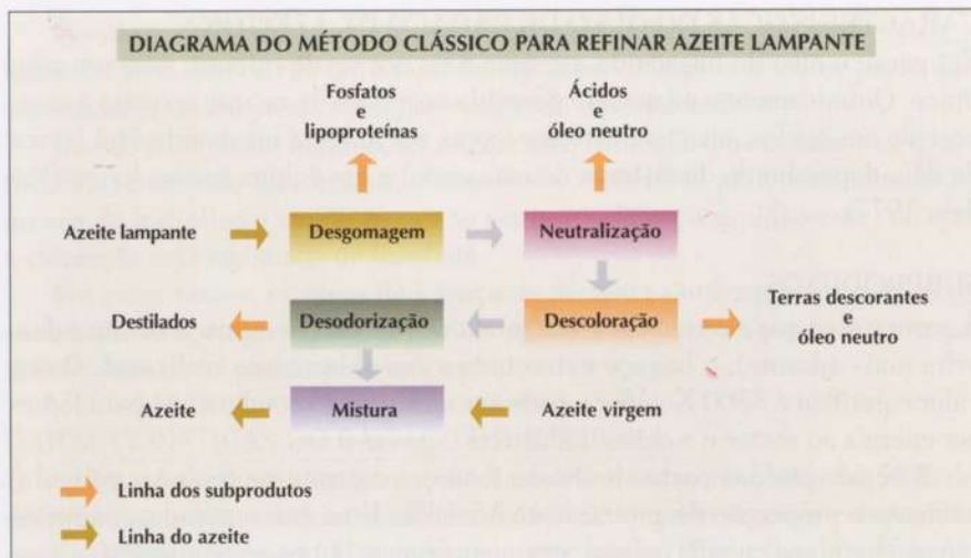
FIGURA 10. Diagrama do método clássico para refinar azeite lampante.
