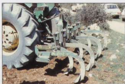
Para a mobilização do olival utiliza-se, em muitas explorações, o cultivador. A lavoura vertical é mais recomendável do que a grade de discos.
