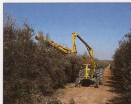
Nas plantações intensivas pode aplicar-se a poda mecânica. Os discos giratórios da máquina podadora produzem cortes que permitem manter a plantação dentro dos volumes de copa desejados.
