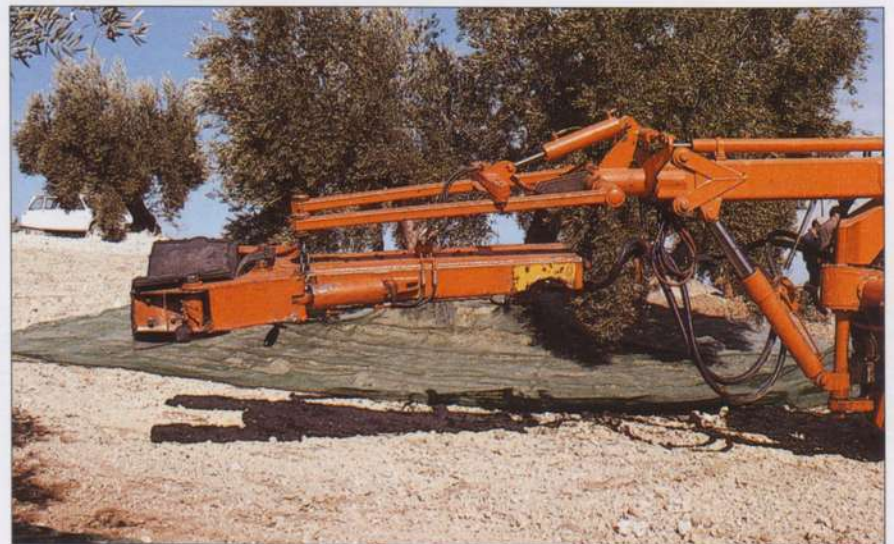
رأس هزاز متعدد الاتجاه يستعمل في القطف الآلي.
