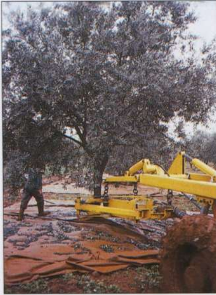
يتطلب القطف الآلي أشجارا ذات جذع واحد، لرفع مردودية الهزاز، الآلة الوحيدة حاليا لحل مشكل القطف. سلالة غاليفو (البرتغال).
