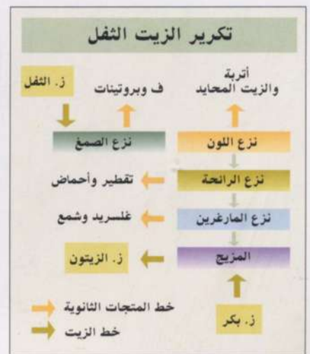
الرسم 12 - بيان التكرير الفيزيائي لزيت الثفل.
