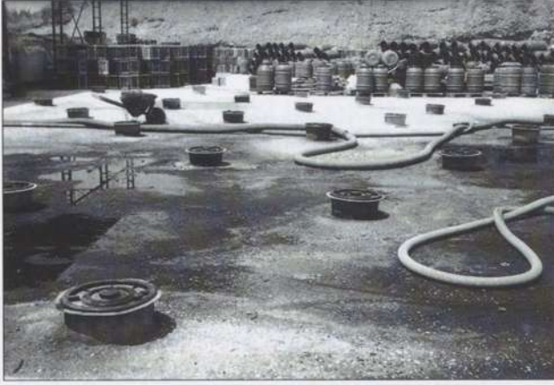
Siyah zeytinlerin fermantasyonu için kullanılan yeraltı poliester fiçiler.
