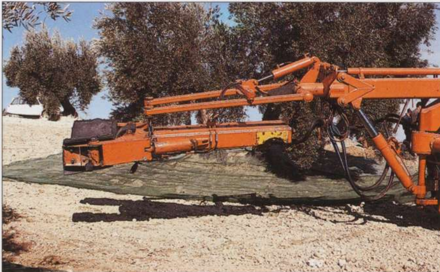
Zeytinin mekanik hasadında kullanılan gövde sarsıcı çok yönlü hasat makinasının «kafa» sına ait ayrıntı.
