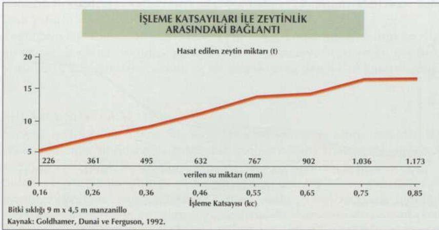
ŞEKİL 25. Bitki sıklığı 9x4,5 m. cv. manzanillo. Kc=0,55 değerine kadar verimin su teminindeki artış ile kesin olarak arttığı birinci safha vardır. Kc nin 0,55 ile 0,75 değerleri arasında tepkinin daha düşük olduğu ikinci safha vardır. Kc=0,75'den sonra verimde artış olmamaktadır.
