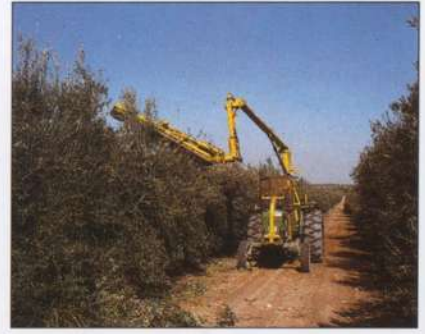
Mekanik budama entansif zeytinliklerde uygulanabilir. İstenen taç hacmini korumak üzere döner diskli budama makinası dalları keser.
