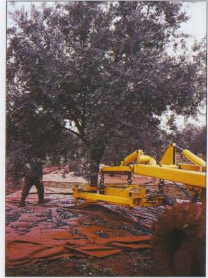
Zeytinin mekanik hasadı problemini bugüne kadar tam olarak çözebilen yegane makineler olan sarsıcıların verimini yükseltmek üzere ağaçların tek gövdeli olmaları şarttır. (cv. Galego, Portekiz).
