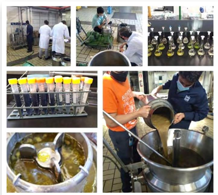
Estrazione di polifenoli in impianti pilota e quantificazione in laboratorio
