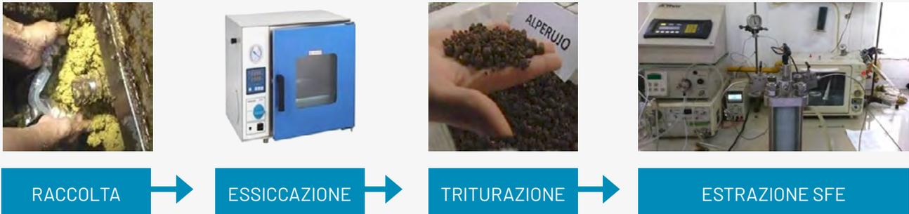
Diagramma del processo di ottenimento di estratti con attività antiossidante mediante tecnologia supercritica a partire dalla pasta di sansa
