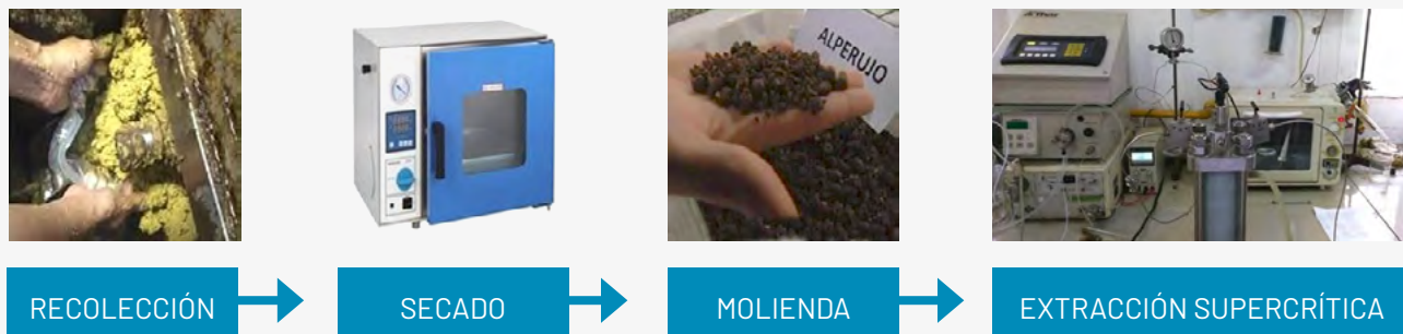
Diagrama del proceso de obtención de extractos con actividad antioxidante mediante tecnología supercrítica a partir del alperujo
